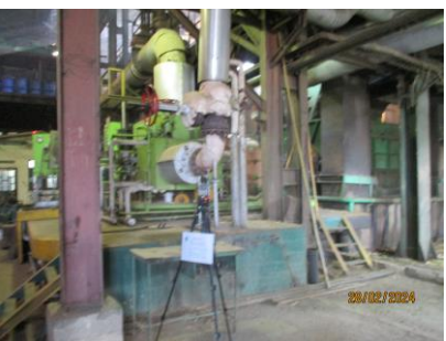
รูปที่ 3.10.1-1 การตรวจวัดระดับเสียงในพื้นที่ทำงาน
